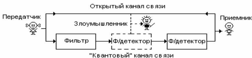
Рис. 6.11. Схема «квантовой» связи
