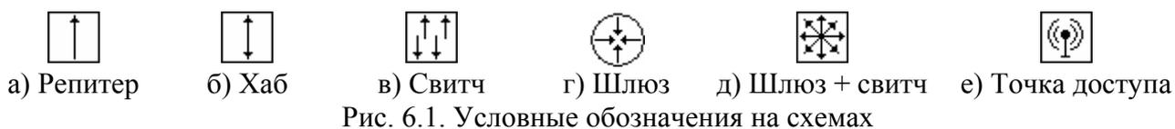
Рис. 6.1. Условные обозначения на схемах
