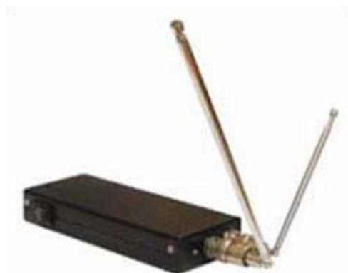
б) Генератор электромагнитного шума
