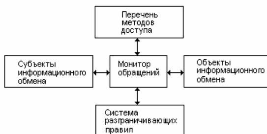
Рис. 2.1. Функциональная схема системы разграничения доступа
