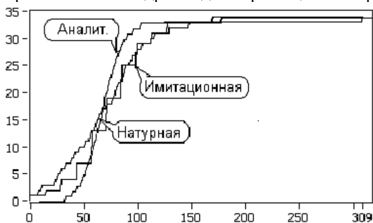
Рис. 1 – Моделирование размножения мобильного агента в локальной сети: количество узлов N=35 , коэффициент размножения \beta=0.2 ед/сек, поиск адресов – случайный.
